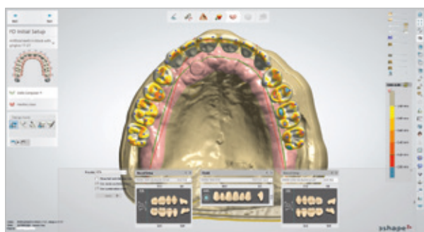
Перевірка оклюзійних контактів і свободи в центриці.
